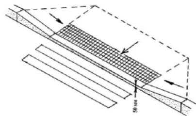
Для доступности МГН в местах пересечения тротуаров и проезжей части предусмотрены съезды (пандусы) с уклоном не более 1:20 (5%), расположенные в удобных пешеходных зонах.
